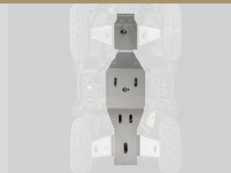
PROTECTION CENTRALE (AVANT ET ARRIERE) CENTRALE BESCHERMING (VOOR- EN ACHE- RAAN) KA-01-0363
